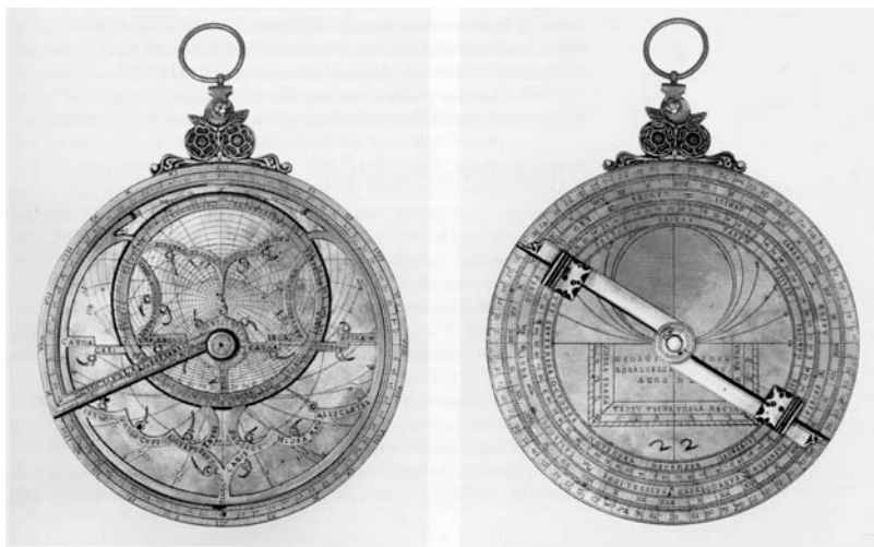
Рис.4. Астролябия Георга Хартмана из Нюрнберга, 1532 год. Изображены как лицевая, так и обратная стороны прибора.
