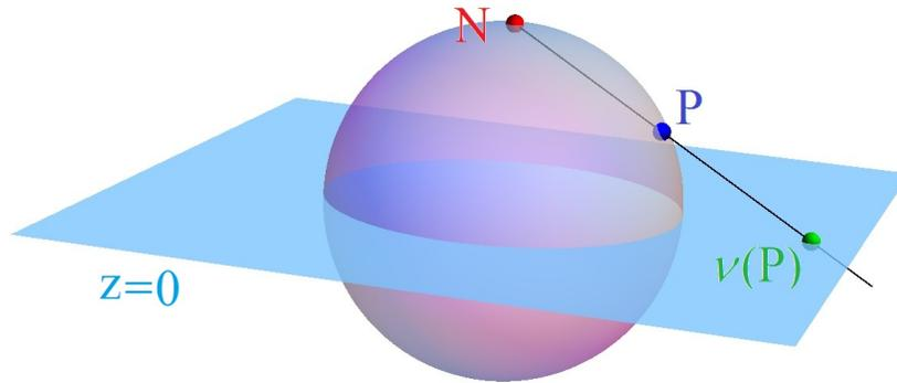
Рис. 4.1: Стереографическая проекция.
