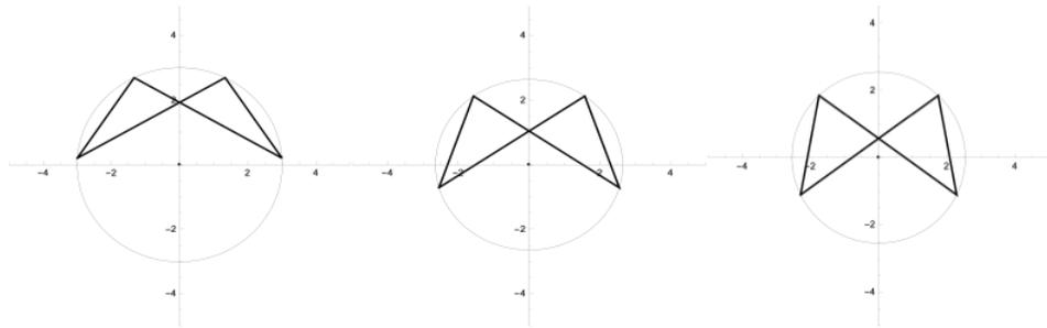
Рис. 8.1: Вписанные в окружности антипараллелограммы со сторонами длины 3 и 5.
