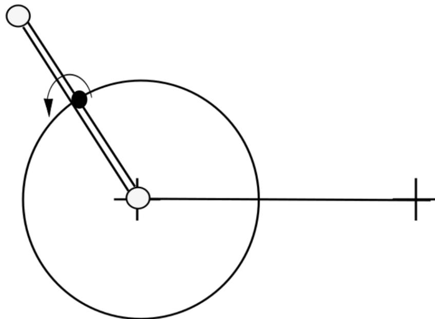
Пример механизма, имеющего в каждом своём положении замерший шарнир
